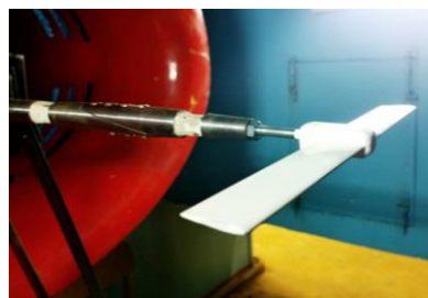
VEI eksperimentālā parauga lāpstiņu caurpūšana aerodinamiskajā caurulē
