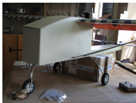
LARIDAE konstrukcija pirms aplīmēšanas ar karbonu
